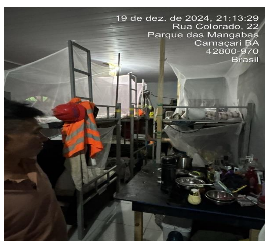
Figuras 4 e 5: alojamentos com quartos que não respeitam a capacidade máxima de trabalhadores, espaço seguro de circulação e colchões, conforme disposto na NR 24
